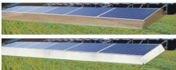
図11 色つきビニールによる光の透過波長の調整
